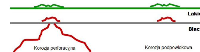
Rys. 4.6. Różnica pomiędzy korozją perforacyjną i pod powłokową
