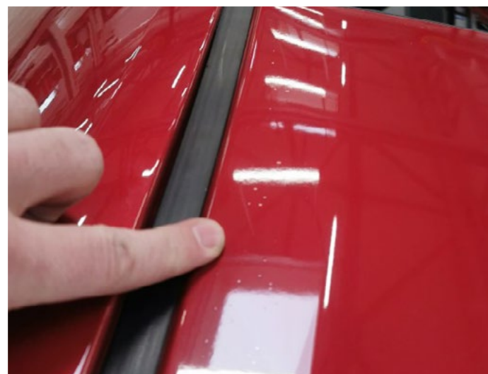
Zdjęcia pokazujące wadę lakierniczą („wilgotniaki”) i ich umiejscowienie (dach samochodu).
