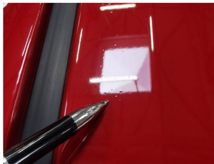
Zdjęcia pokazujące wadę lakierniczą („wilgotniaki”) i ich umiejscowienie (dach samochodu).
