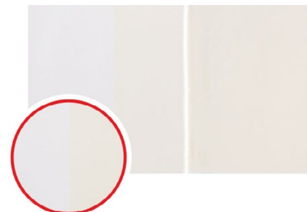
Przebarwienie na lakierze z katalogu wad lakierniczych Źródło: https://novol.com/wady-aplikacyjne/17/przebarwienie
