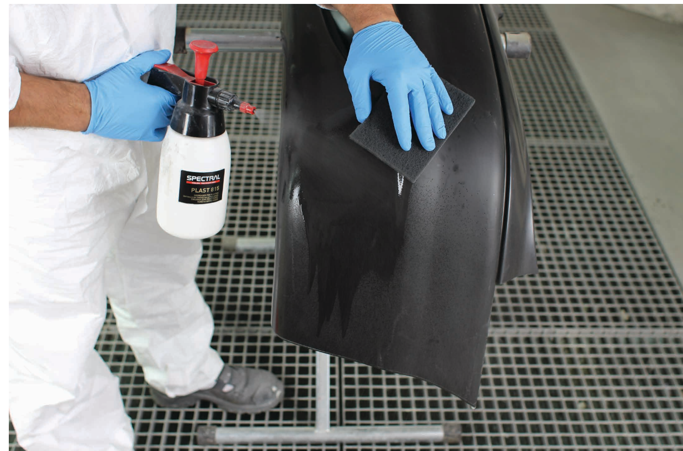
Fot. Matowanie włókniną ścierną połączone z odtłuszczaniem za pomocą antystatycznego zmywacza antysilikonowego (Spectral PLAST 815).
