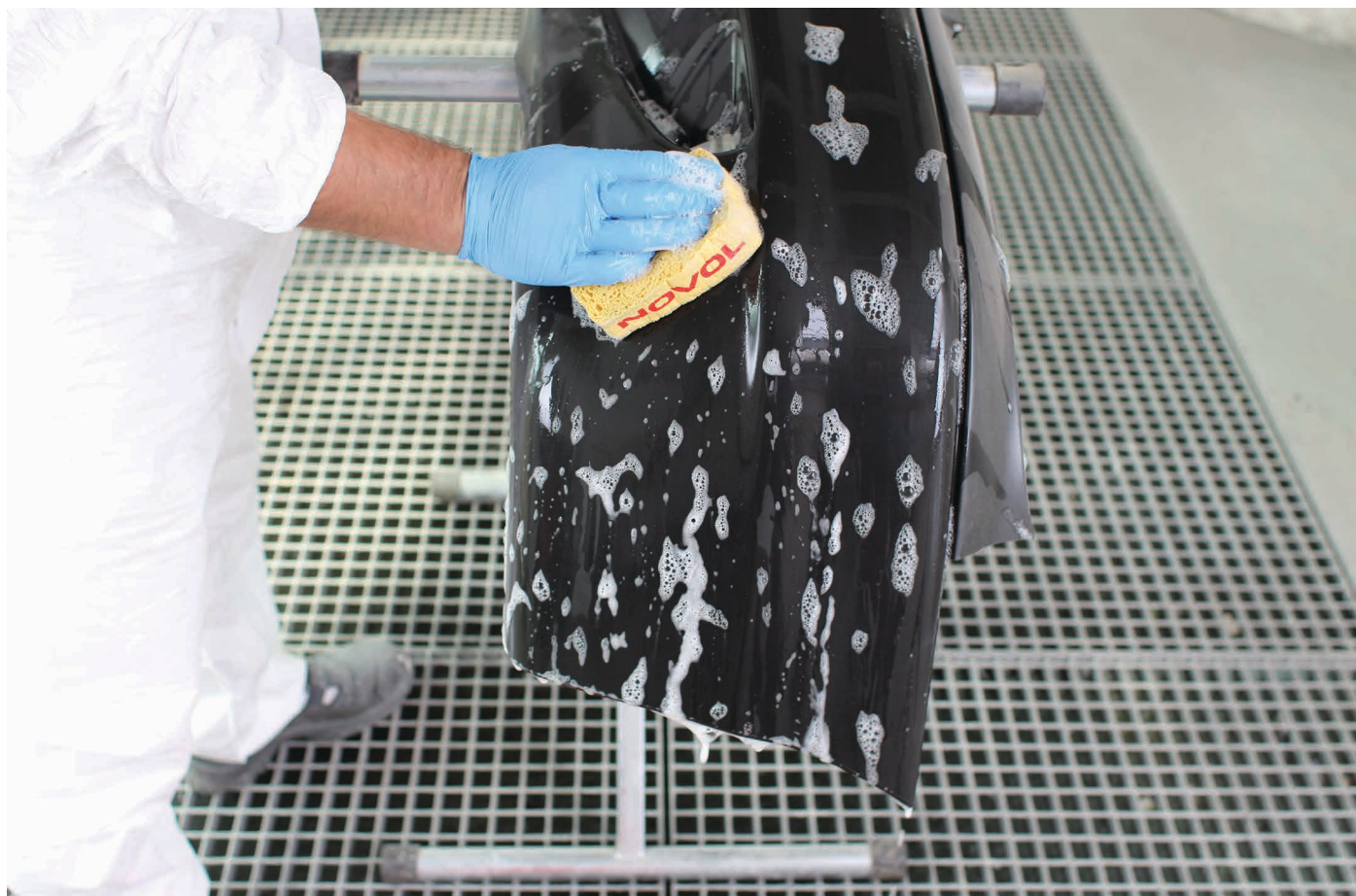
Fot. Mycie powierzchni tworzywa sztucznego ciepłą wodą z detergentem.
