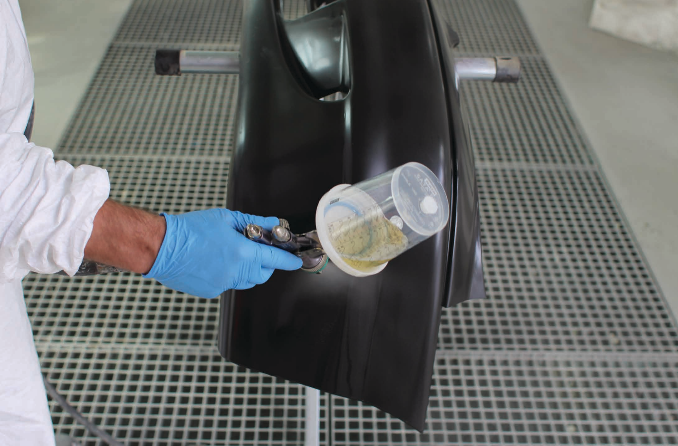
Fot. Aplikacja podkładu zwiększającego przyczepność (Spectral EXTRA 705).
