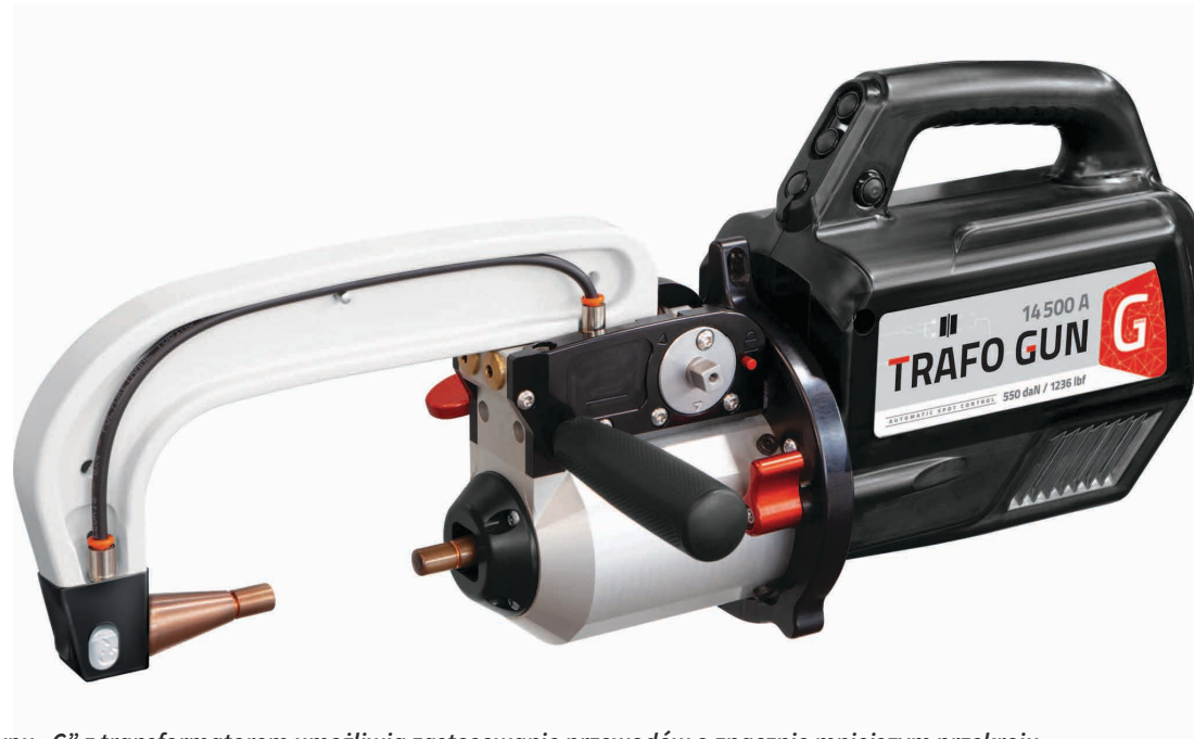
Fot. Uchwyt typu „C” z transformatorem umożliwia zastosowanie przewodów o znacznie mniejszym przekroju oraz może być stosowany przy mniejszym zabezpieczeniu linii o niższych parametrach. (GYS.pl)
