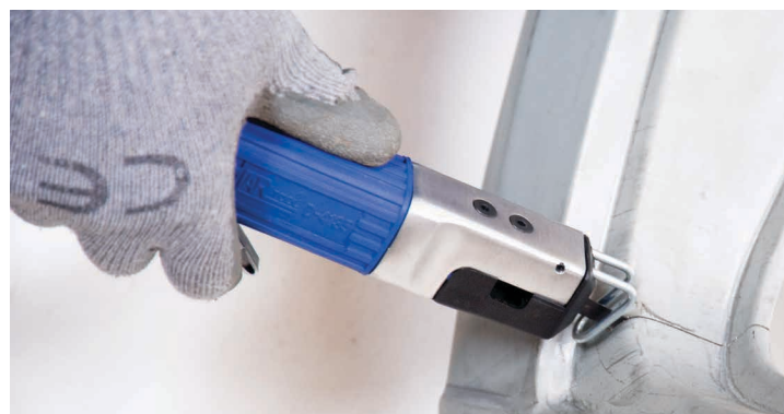
Fot. Cięcie karoserii przy pomocy piły szablastej. (EZ-DENT)
