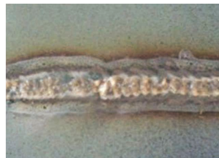
Fot. Spoina wykonana metodą lutowania. (Telwin)
