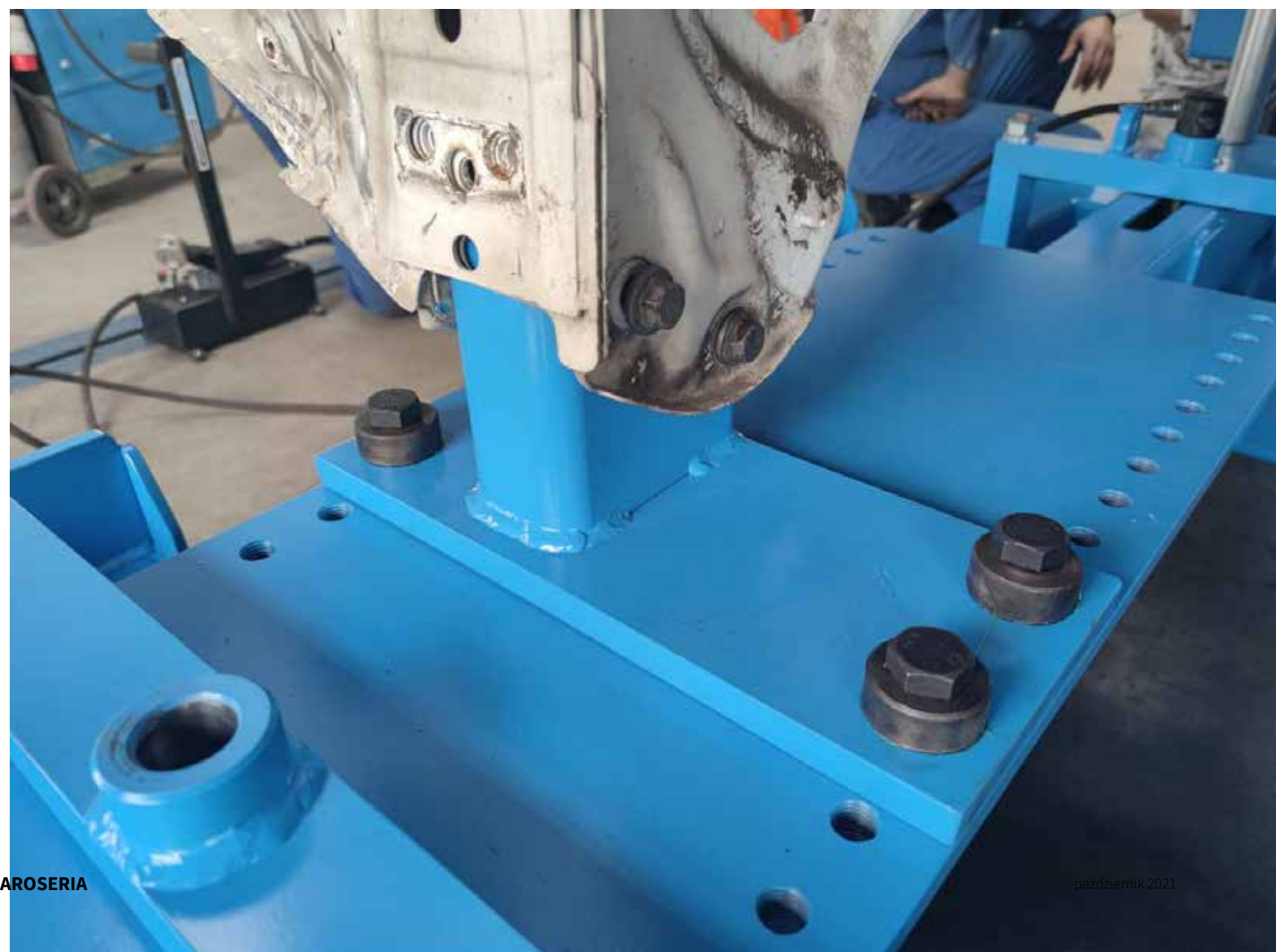
Fot. 3. Mocowanie kabiny VOLVO. (HERKULES)
