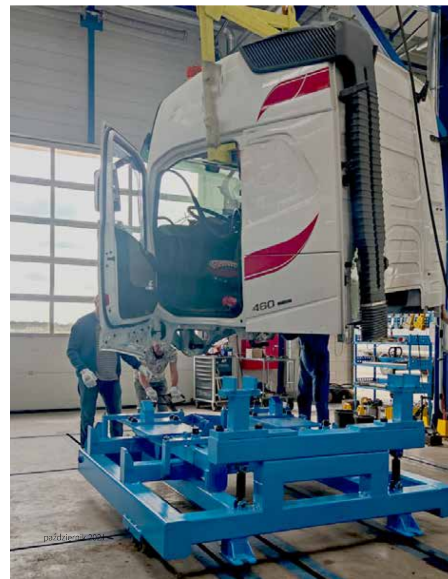
Fot.4. Ustawianie kabiny wykonywane jest zwykle przy pomocy urządzeń suwnicowych lub wciągarek. (HERKULES)
