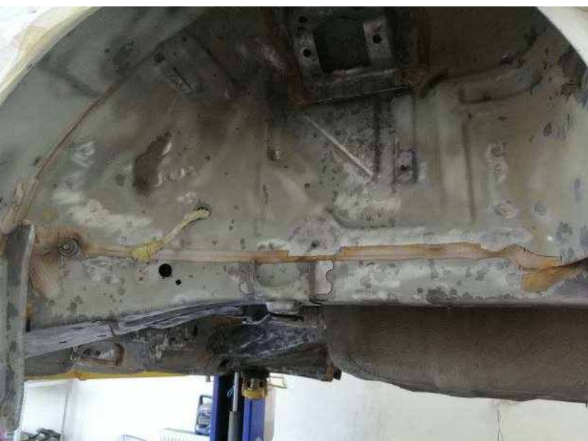
Fot. 3. Nadkole po operacji piaskowania. (Iron Garage Jeleśnia)
