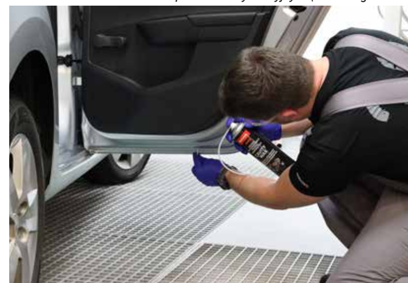
Fot. 11. Zabezpieczenie przestrzeni zamkniętej klapy tylnej przy użyciu wosku CAVITY WAX - ŚRODEK DO KONSERWACJI PROFILI ZAMKNIĘTYCH. (NOVOL)
