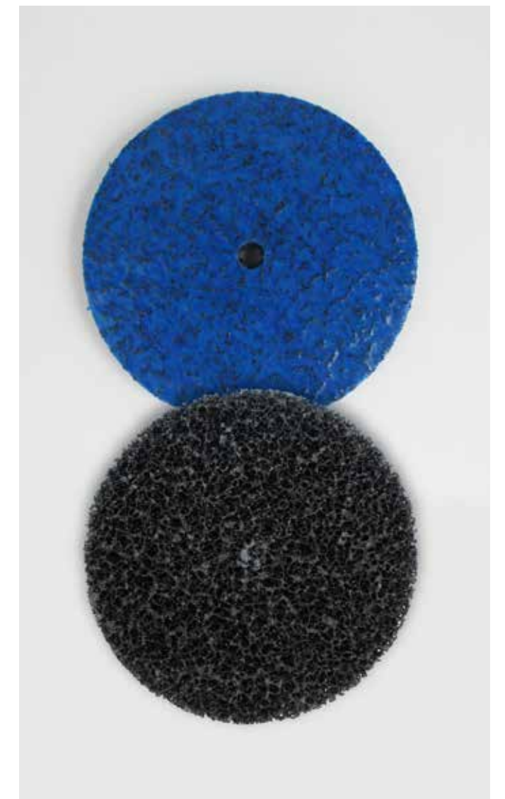
Fot. 2. Tarcze nylonowe do usuwania starych powłok lakierowych, mas ochronnych, uszczelniających oraz rdzy w trudno dostępnych miejscach, a także do oczyszczenia spawów. Wersja niebieska z dodatkową impregnacją zwiększającą trwałość produktu. (Quattro - NOVOL)
