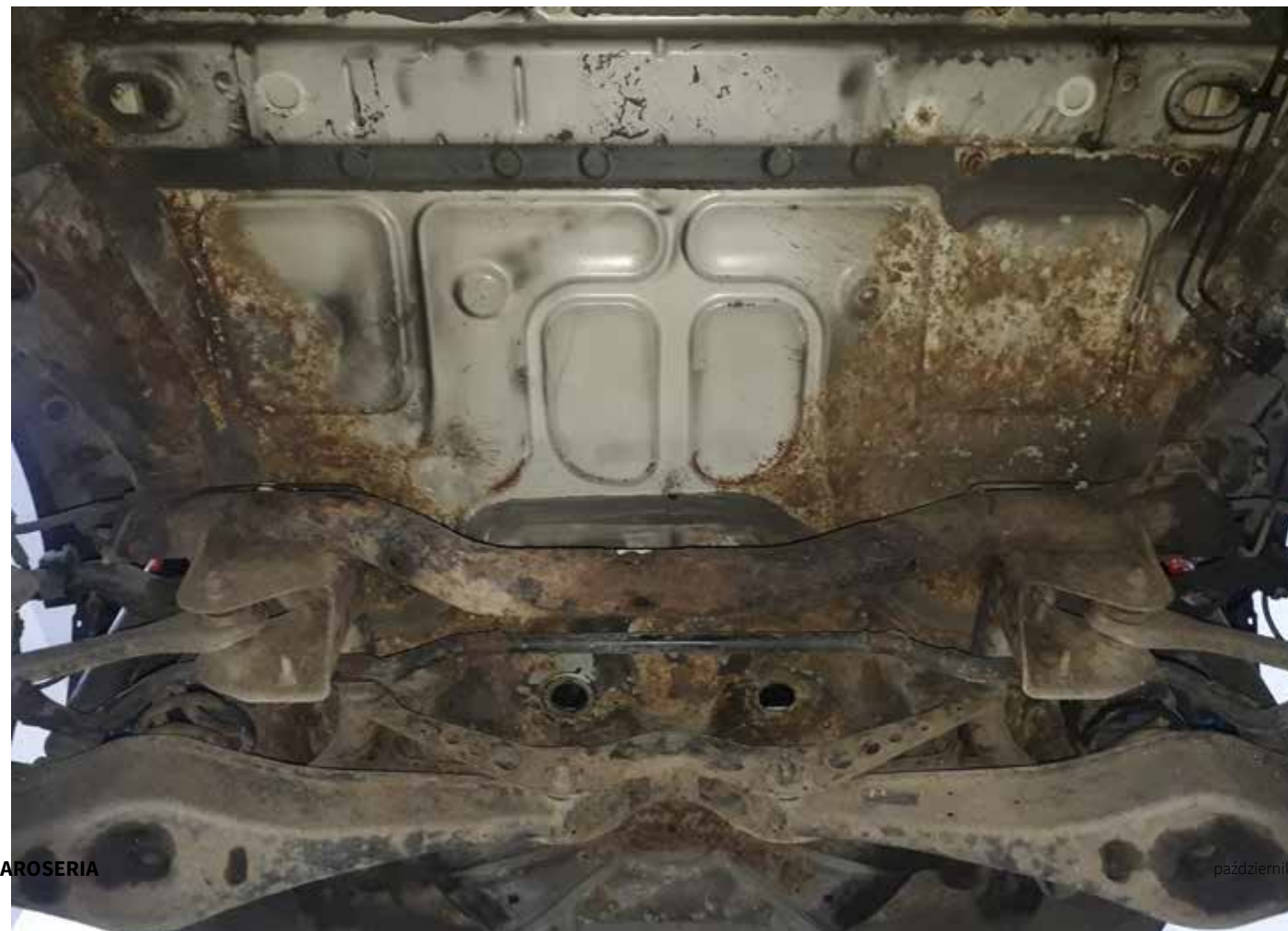
Fot. 1. Przykładowy wygląd zardzewiałego podwozia po kilku latach eksploatacji. (Iron Garage Jeleśnia)
