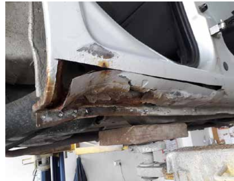
B. Po wycięciu przerdzewiałych miejsc.
