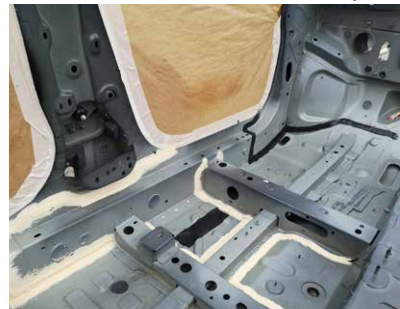
Fot. 8. Uszczelnianie połączeń zakładkowych blach za pomocą masy natryskowej STP. (NOVOL)
