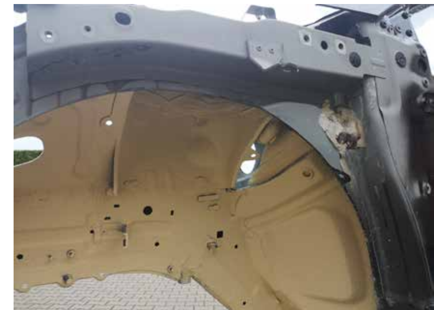
Fot. 9. Uszczelnianie połączeń nadkola za pomocą masy natryskowej STP. (NOVOL)
