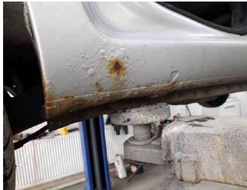
A. Przerdzewiały próg przed rozpoczęciem prac blacharskich.
