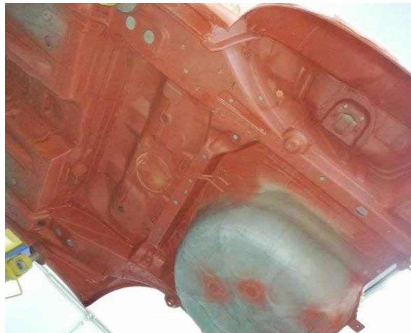
Fot. 6. Zabezpieczenie za pomocą podkładu reaktywnego NOVOL PROTECT 340. (Iron Garage Jeleśnia)
