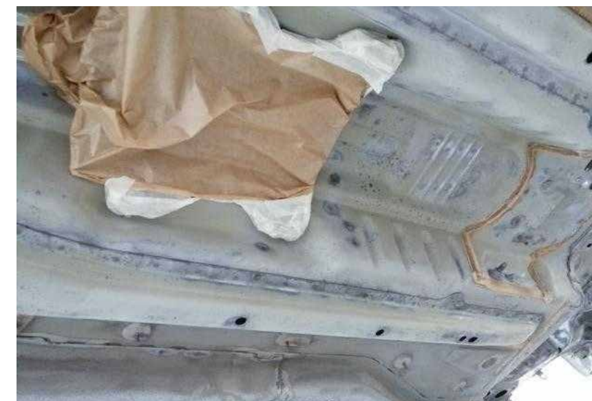
Fot. 5. Maskowanie przed aplikacją środków ochronnych. (Iron Garage Jeleśnia)
