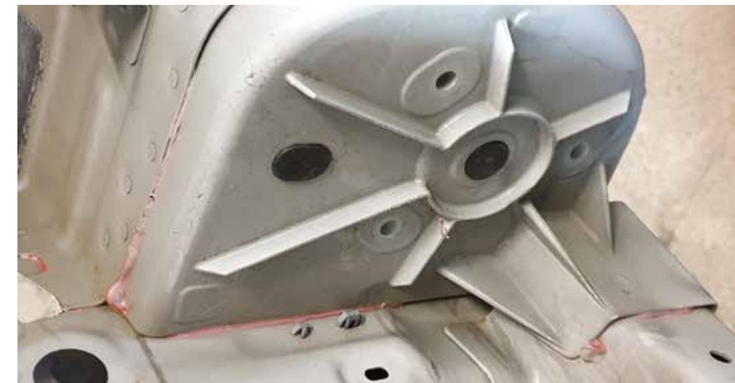
Fot. 4, 5. Połączenia elementów odlewanych z wykonanymi z blachy. Widoczny klej oraz elementy mity łączące warstwy materiału. Fragment karoserii Modelu „X”. (BR)
