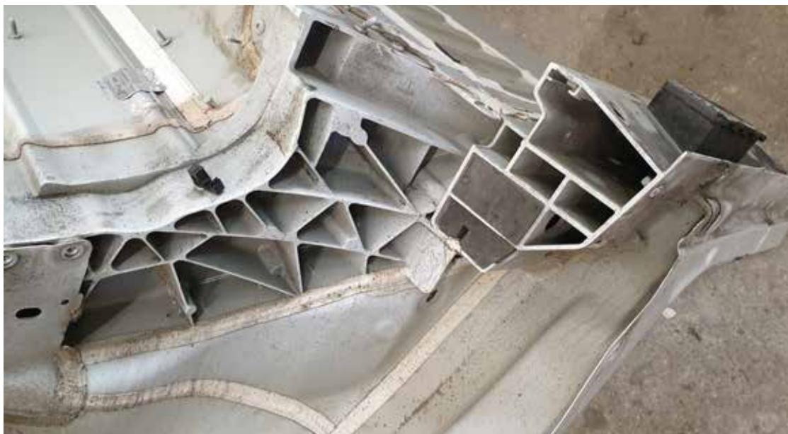
Fot. 1, 2. Elementy odlewane metodą ciśnieniową w połączeniu z wykonanymi z blach aluminiowych. Fragment karoserii Modelu „X”. (BR)
