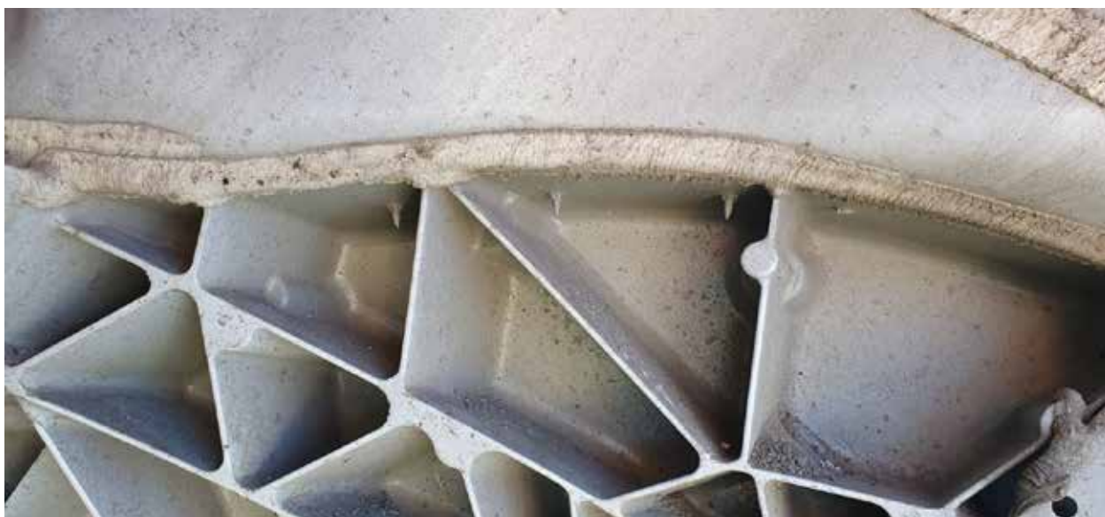
Fot. 3. Elementy odlewane metodą ciśnieniową w połączeniu z wykonanymi z blach aluminiowych. Widoczne elementy ustalająco-mocujące przebite przez łączone warstwy materiału. Fragment karoserii Modelu „X”. (BR)
