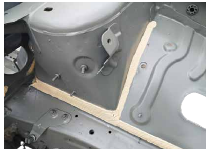
Rys. 11. Uszczelnienie połączeń przy kielichu amortyzatora. (NOVOL)
