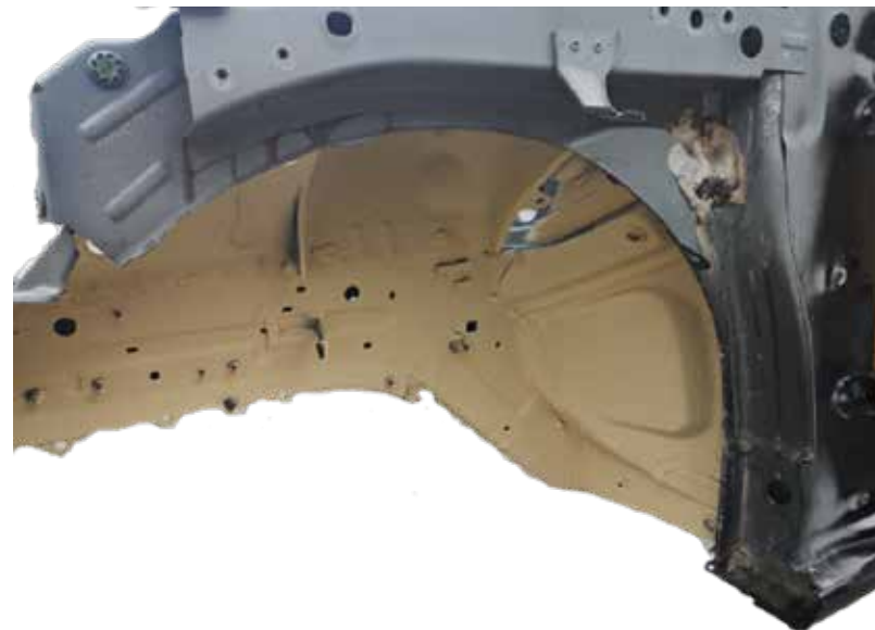
Rys. 8. Zabezpieczenie i wygłuszenia nadkola za pomocą masy STP. (NOVOL)
