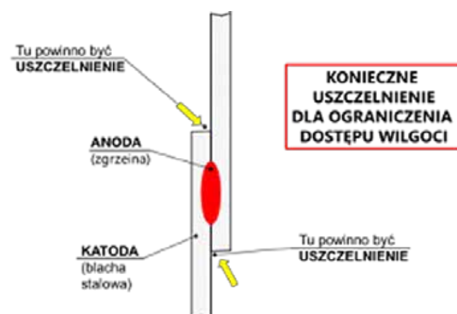
Rys. 2. Zakładkowe połączenie zgrzewane. (NOVOL)
