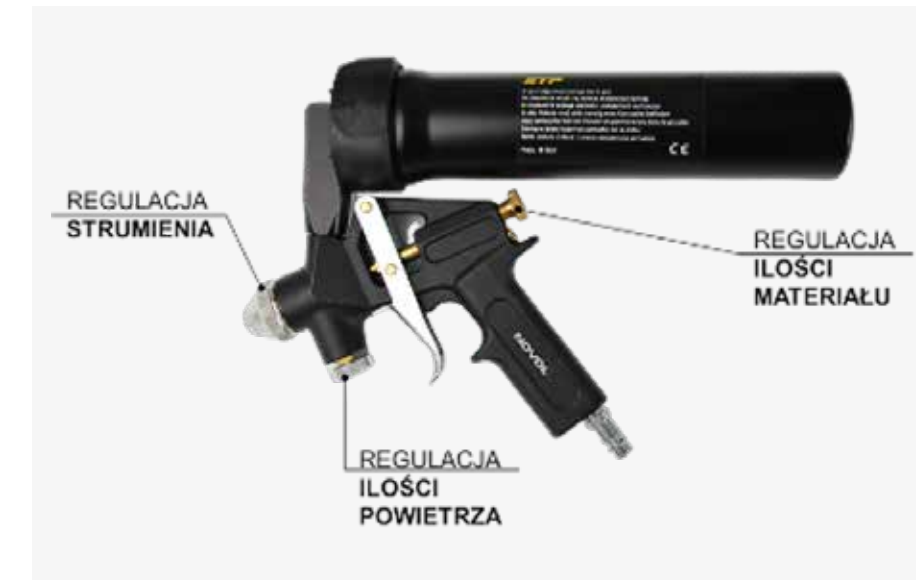
Rys. 12. Pistolet do natrysku mas uszczelniających STP ze wskazanymi możliwościami regulacji parametrów aplikacyjnych. (NOVOL)
