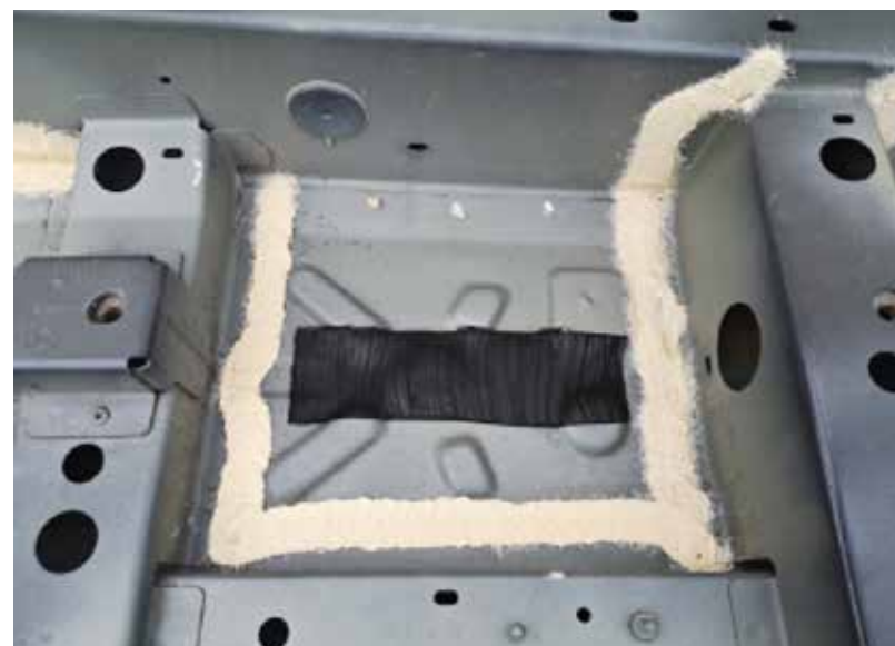
Rys. 10. Różne warianty ściegów wykonanych za pomocą masy STP. (NOVOL)
