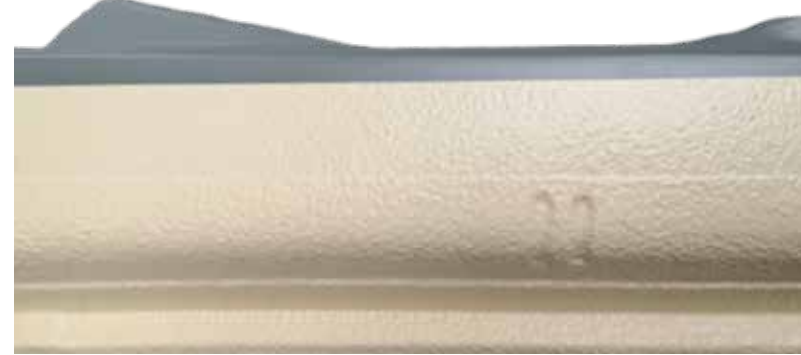
Rys. 7. Masa STP jako zabezpieczenie progu w wariantcie natryskowym ze strukturą „baranka”. (NOVOL)
