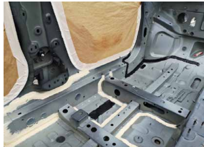
Rys. 9. Odtworzenie ściegów fabrycznych przy użyciu mas STP. (NOVOL)
