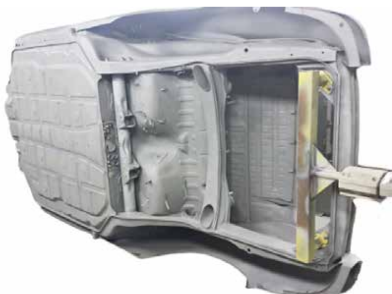
Rys. 2. Podwozie po obróbce strumieniowo-ścierniej (piaskowanie).
