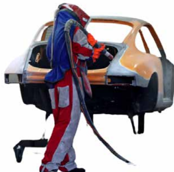
Rys. 3. Oczyszczanie karoserii przy użyciu kulek z tworzywa sztucznego. (fot. carblast.pl)
