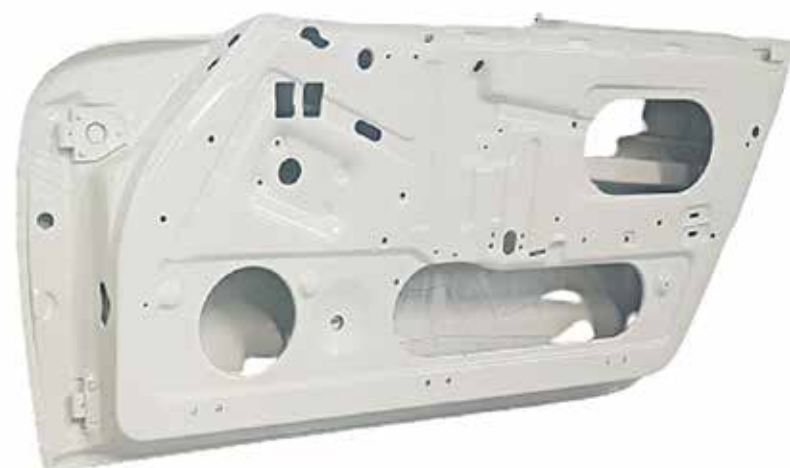
Rys. 5. Karoseria i elementy po zabezpieczeniu podkładem epoksydowym NfCC EPOXY PRIMER.
