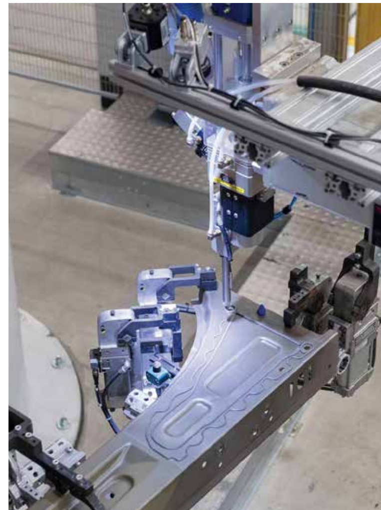
Fot. 2 i 3. Proces klejenia w produkcji nowoczesnej karoserii samochodowej. (SIKA)
