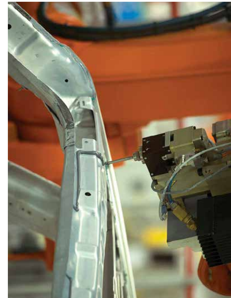
Fot. 2 i 3. Proces klejenia w produkcji nowoczesnej karoserii samochodowej. (SIKA)
