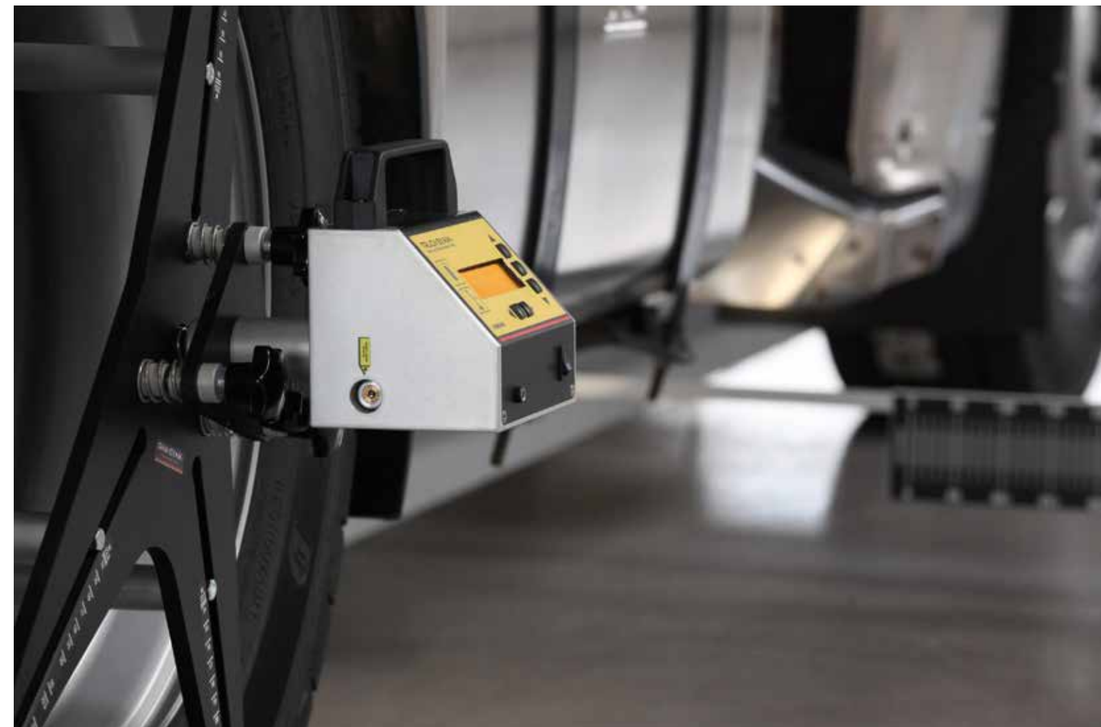
Fot. Pomiar geometrii układu jezdnego. (HERKULES)
