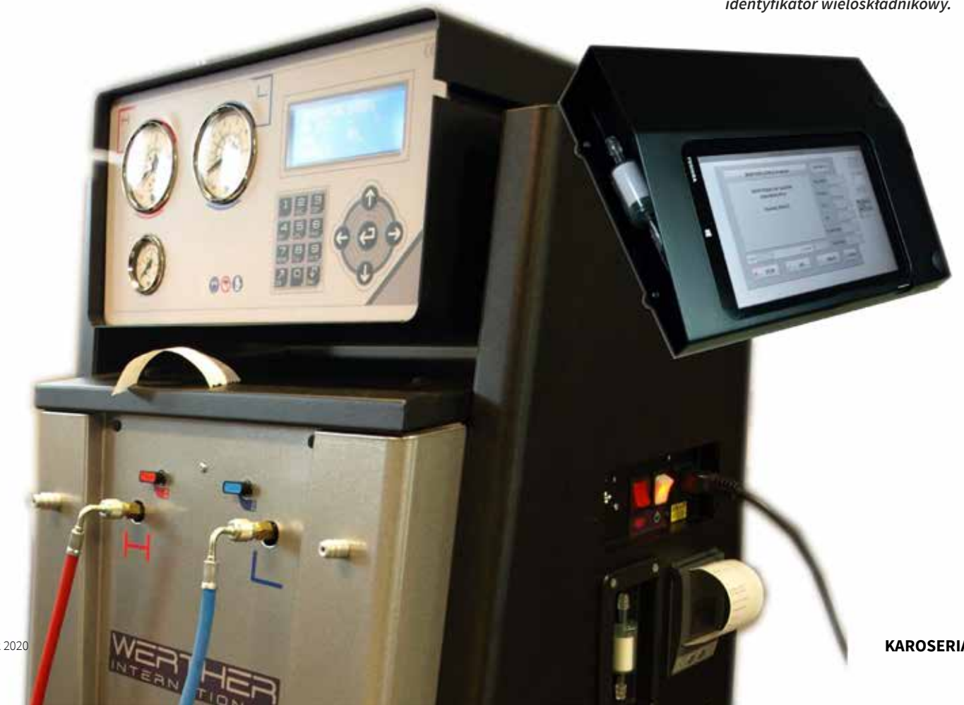
Fot. WERTHER AC1000 – stacja obsługowa do czynnika R1234yf wyposażona opcjonalnie w niezależny identyfikator wieloskładnikowy.
