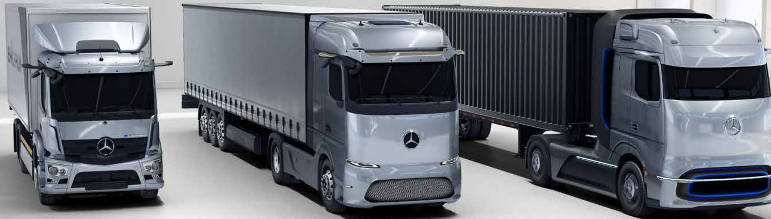
Fot. Trzy zelektryfikowane pojazdy Mercedes-benz. Od lewej: eActros – pojazd dystrybucyjny z elektrycznym napędem akumulatorowym o zasięgu 200 km, eActros LongHaul – dalekobieżny z elektrycznym napędem akumulatorowym o zasięgu 500 km i GenH2 Truck – z ogniwami paliwowymi o zasięgu 1000 km. W 2021 roku rozpocznie się produkcja eActrosa. (Fot. Daimler)
