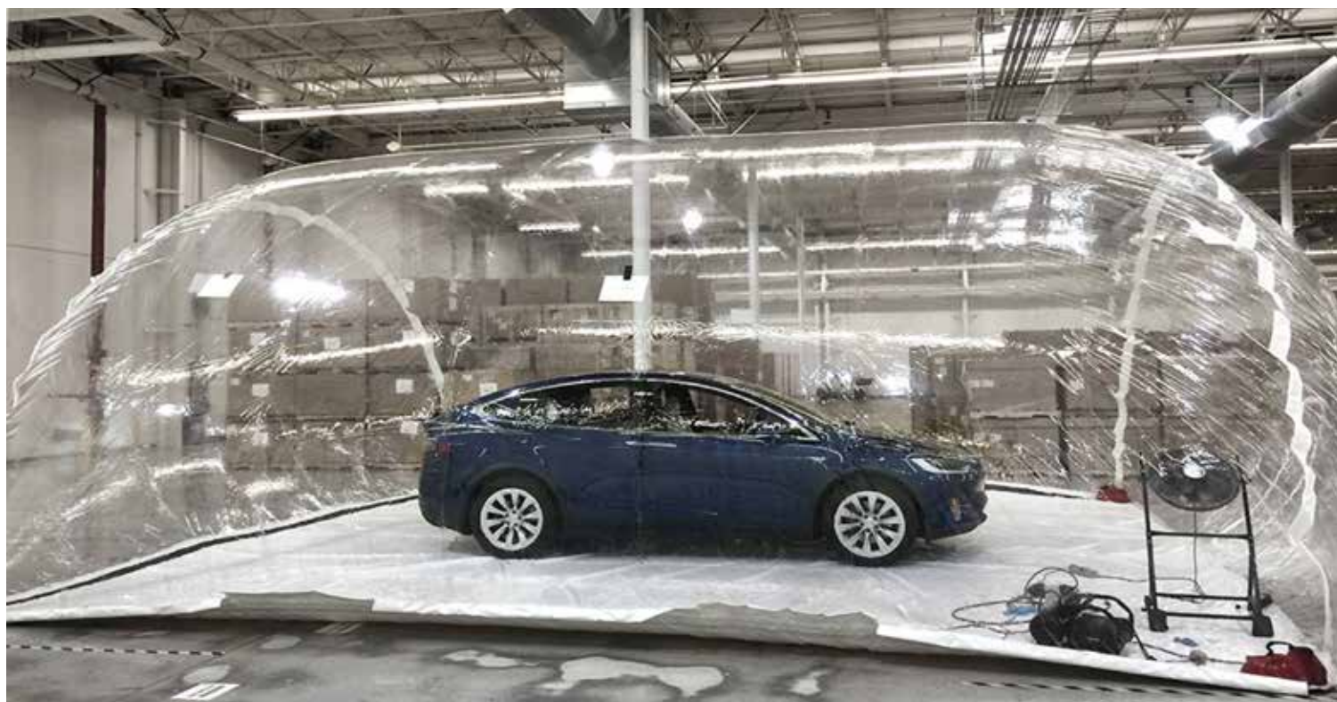
Fot. System Bioweapon Defense Mode w trakcie testów nie tylko całkowicie wyczyścił powietrze w kabinie, ale w następnych minutach zaczął również oczyszczać powietrze na zewnątrz samochodu, zmniejszając poziom PM 2,5 o 40%. (fot. Tesla)
