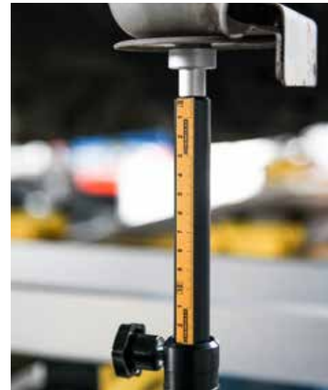
Fot. Pomiar mechaniczny 3D podczas naprawy na stanowisku do ustawiania punktów bazowych (Fot. HERKULES).
