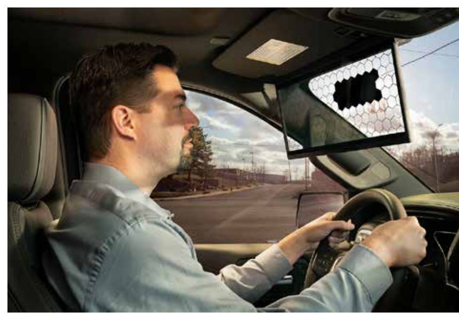
Fot. W osłonie przeciwsłonecznej opracowanej przez Boscha inteligentne algorytmy oparte na sztucznej inteligencji stale analizują, gdzie patrzy kierowca, i przyciemniają niewielki obszar na wyświetlaczu, aby w cieniu pozostawały tylko jego oczy. (Fot. Bosch)
